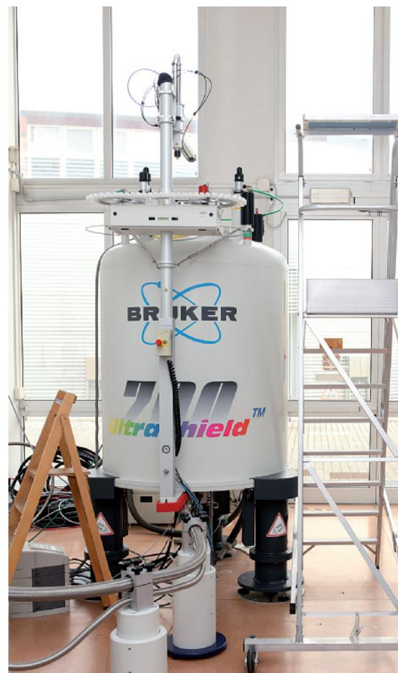
**2- Spettrometro NMR operante a 700 MHz, impiegato per esperimenti nella ricerca di principi attivi farmaceutici.**
